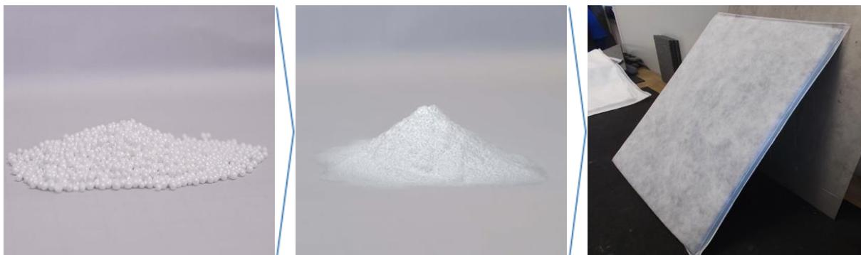
Abbildung 3-12: Aus dem Sumfoam-Granulat (links) wurde in einem weiteren Verarbeitungsschritt ein feines Pulver (Mitte) hergestellt, welches die Performance hinsichtlich der Evakuierbarkeit im VIP deutlich verbessert. Rechts abgebildet ist die vorgepresste Form des Pulvers in einem Vlies, welches als Vorbereitung zur finalen VIP-Herstellung dient.
