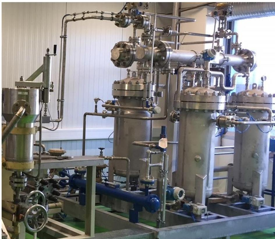
Abbildung 3-8: Pilotanlage für Hochdruck-CO<sub>2</sub>-Prozesse. Auf dieser Anlage können die für eine Anlagenkonstruktion relevanten Schäumparameter getestet werden.
