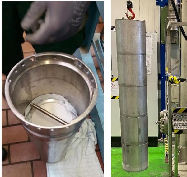
Abbildung 3-6: Links: Mit Polymer-Rohmaterial befüllter Sumfoam-Einsatzkorb vor der Schäumung. Rechts: Entnahme des Einsatzkorbes aus dem CO<sub>2</sub>-Druckbehälter.
