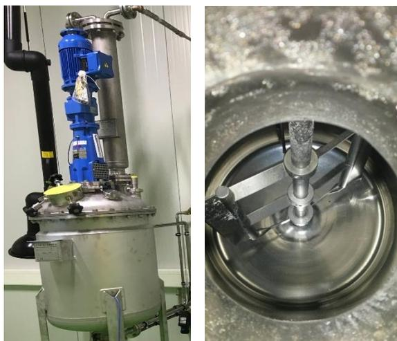
Abbildung 3-15: Polymerisationsreaktor, für die nächste Skalierungsstufe. Links ist eine Außenansicht des Reaktors mit dem entsprechendem Rührwerk rechts abgebildet.
