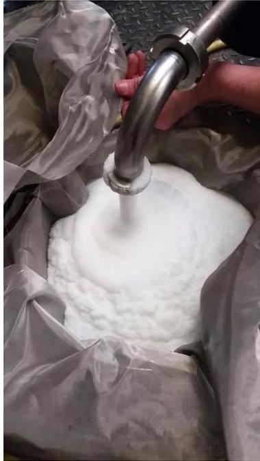
Abbildung 3-3: Links: Polymerisationsreaktor. Mittels Suspensionspolymerisation wird das flüssige Monomer in Polymer-Granulat überführt. Rechts: Nach Abschluss der Polymerisation wird das fertige Polymer-Granulat abfiltriert und im Anschluss gewaschen und getrocknet.
