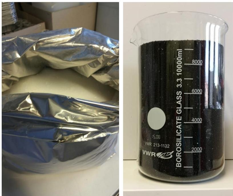
Abbildung 3-4: Links: Weißes Polymer-Granulat, das externhergestellt wurde. Rechts: Schwarzes Polymer-Granulat, das während der Polymerisation mit einem kohlenstoffbasierten Infrarottrübungsmittel versetzt wurde.
